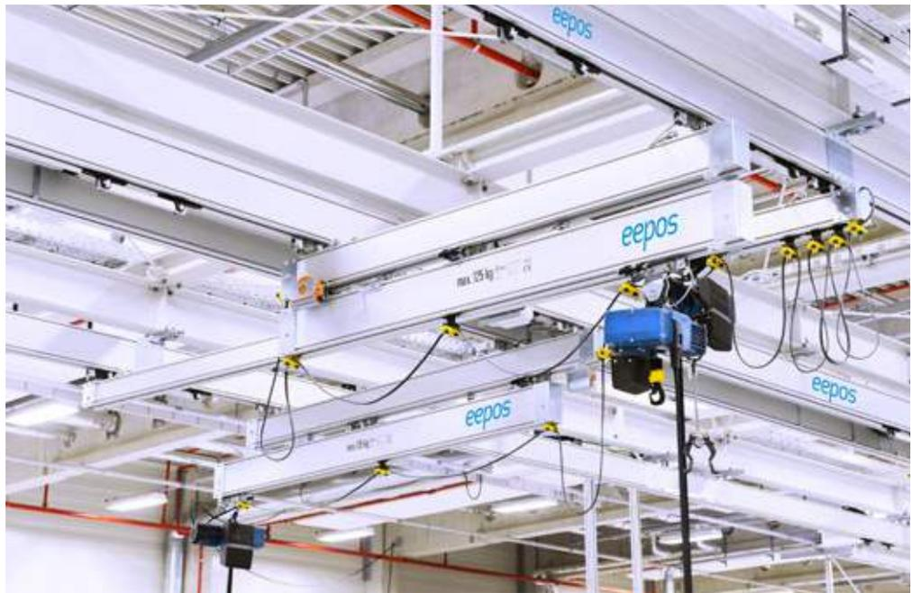
Teleskopierbare eePOS Aluminiumkrane an der Fendt Hauptmontage
