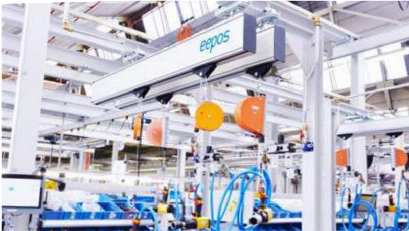
eepos Profile mit Fahrwerk in der Fendt Traktorenvormontage
